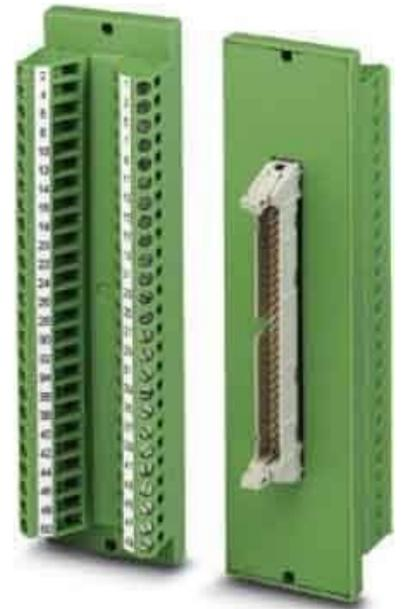
Phoenix Contact Passive Übergabemodule mit hochpoligen Steckve DFLK 26 Ausführung elektrischer Anschluss, feldseitig Schraubanschluss, Ausführung elektrischer Anschluss, steuerseitig Flachstecker, Polzahl 26, Bemessungsspannung 50V, Bemessungsstrom 1A, Verschmutzungsgrad 2, Tiefe 49mm, Breite 39mm, Höhe 83,4mm, Montageart sonstige, Das VARIOFACE-Durchführungs-Modul realisiert eine 1:1-Verbindung zwischen Schraubanschlussklemmen und einer IDC / FLK - Stiftleiste
