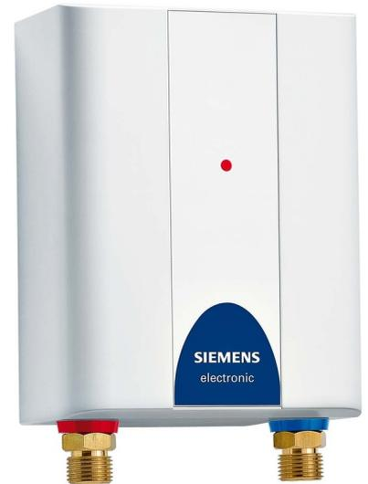
Siemens Haustechnik Durchlauferhitzer 7,2 KW ÜT DE 08111 Nennleistung 7,2kW, Nennspannung 1 230V, Temperaturanzeige ohne, Montageart Übertisch, Heizsystem Blankdraht, Schutzart (IP) IP24, Art der Regelung elektronisch, Höhe 185mm, Breite 140mm, Tiefe 88mm, 2 in 1 System für Druck-Armatur oder Niederdruck-Armatur, verbraucht nur dann Energie, wenn Wasser gezapft wird, geeignet für Handwaschbecken.
