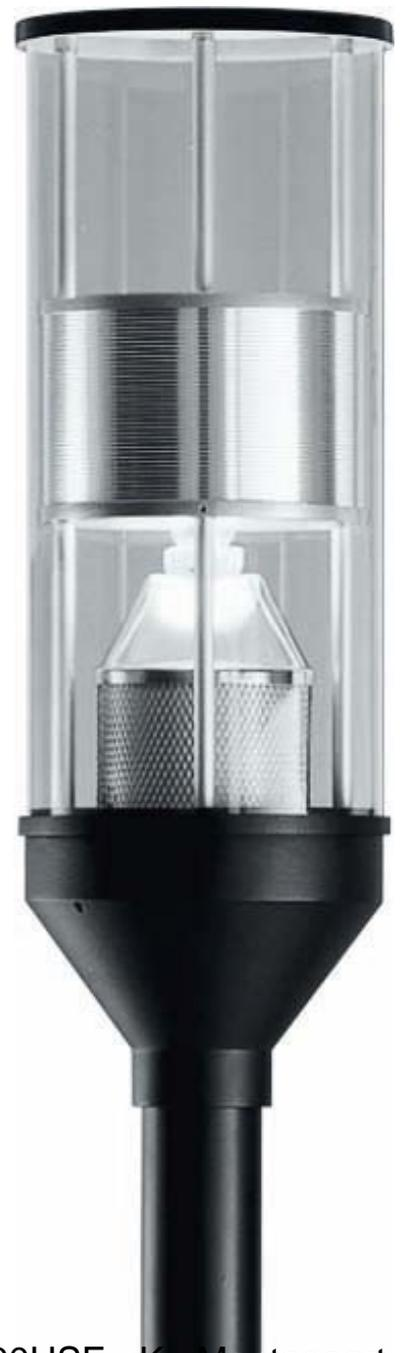
Trilux Zylinderleuchte asym Spiegelenoptik 9801SA/100HSE K Montageart Aufsatz, Leuchtmittel Natriumdampf-Hochdrucklampe, Fassung E40, Schaltung parallelkompensiert, Werkstoff des Gehäuses Aluminium, Gehäusefarbe schwarz, Werkstoff der Abdeckung Kunststoff transparent, Geeignet für Leuchtmittellanzahl 1, Max.
