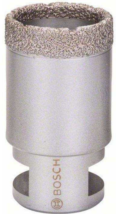
Bosch Power Tools Dia-Trockenbohrer für WS 2 608 587 121 Nennmaß 35mm, Aufnahmesystem Gewindeaufnahme, Arbeitstiefe 35mm, Beschichtung Diamant, Geeignet für weiche Wandfliesen bis hin zu sehr harten Bodenfliesen und Naturstein.
