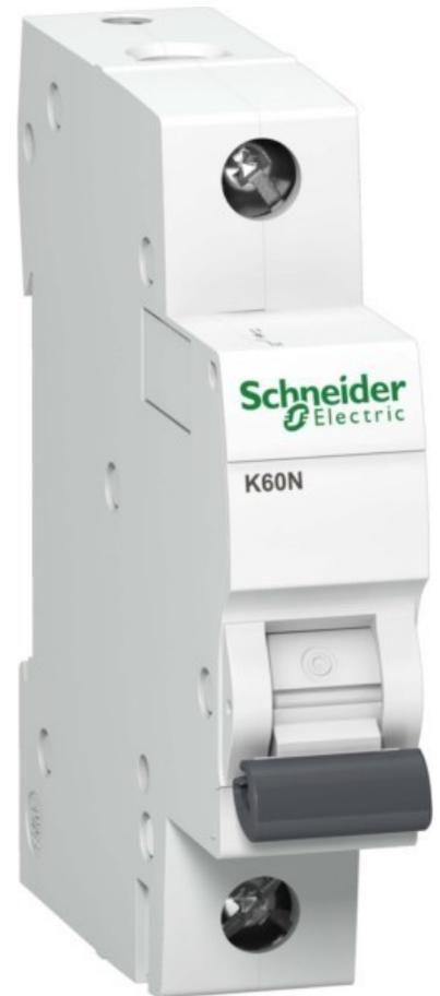
Schneider Electric LS-Schalter 1P 13A C K60N A9K02113 Auslösecharakteristik C, Polzahl (gesamt) 1, Anzahl der abgesicherten Pole 1, Bemessungsstrom 13A, Bemessungsspannung 230V, Spannungsart AC, Breite in Teilungseinheiten 1, Mit Doppelfunktionsklemme für getrennten Anschluss von Gabelkammschiene und Kabel.
