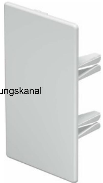
OBO Bettermann Vertr Endstück halogenfrei 60x110mm, PC/ABS Igr WDKH-E60110LGR Höhe 110mm, Breite 60mm, Ausführung links/rechts, Werkstoff Kunststoff, Werkstoffgüte PVC, Halogenfrei, Oberfläche unbehandelt, Farbe lichtgrau, RAL-Nummer 7035, Befestigungsart aufrastbar, Endstück zum Verschließen der halogenfreien WDK-Kanäle
