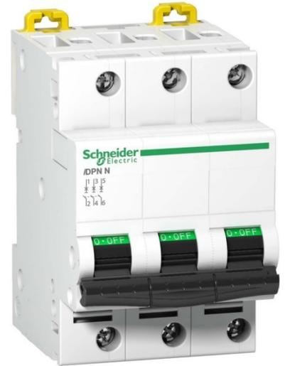
Schneider Electric LS-Schalter 3P 13A D IDPN A9N21728 Auslösecharakteristik D, Polzahl (gesamt) 4, Anzahl der abgesicherten Pole 3, Bemessungsstrom 13A, Bemessungsspannung 400V, Spannungsart AC, Frequenz 50 ...
