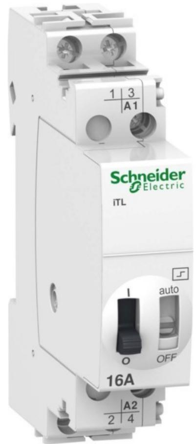
Schneider Electric Fernschalter ITL 2P 16A 48VAC A9C30212 Montageart DIN-Schiene, Breite in Teilungseinheiten 1, Anzahl der Schließer 2, Anzahl der Öffner 0, Anzahl der Wechsler 0, Steuerspannung 1 48 ...
