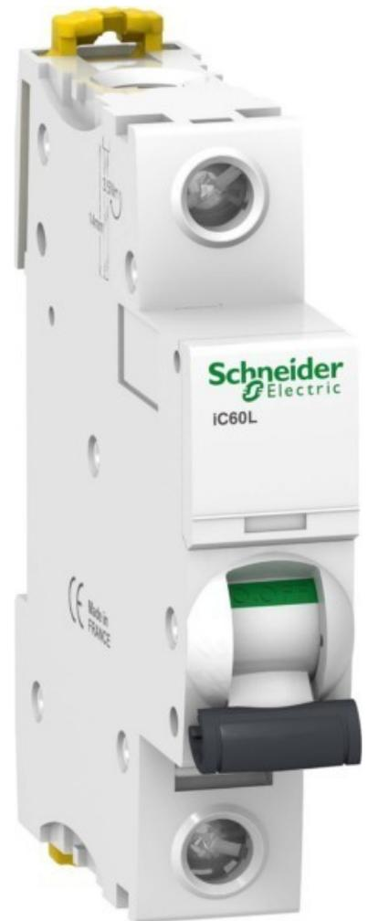
Schneider Electric LS-Schalter 1P 16A C IC60L A9F94116 Auslösecharakteristik C, Polzahl (gesamt) 1, Anzahl der abgesicherten Pole 1, Bemessungsstrom 16A, Bemessungsspannung 230V, Spannungsart AC, Frequenz 50 ...
