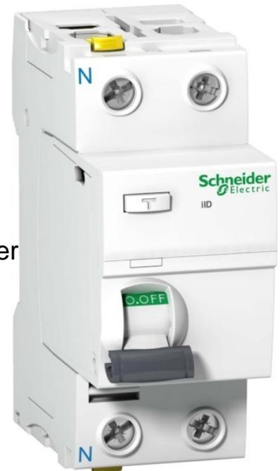
Schneider Electric FI-Schalter 2P 100A 30mA Typ A A9Z21291 Polzahl 2, Bemessungsspannung 400V, Bemessungsstrom 100A, Bemessungsfehlerstrom 0,03A, Montageart DIN-Schiene, Fehlerstrom-Typ A, Zusatzeinrichtungen möglich, Breite in Teilungseinheiten 2, Mit Doppel-Anschlussklemme für Stift-Phasenschiene und Kabel, Frontseitige Fehlermeldeanzeige, Vorneliegendes Befestigungselement, für Hilfsschaltermontage linksseitig
