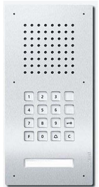
Siedle&Söhne Türstation Audio Classic, eds, 1WE CL ACOM 01 B-02 Anzahl der Ruftasten 1, Montageart Unterputz, Mit Abdeckung, Schutz gegen Vandalismus, Farbe Silber, Installationstechnik Bus-System, Höhe 356mm, Breite 171mm, Tiefe 2mm, Classic-Türstation für den In-Home-Bus mit Edelstahl-Front, V4A gebürstet, mit Unterputz-Gehäuse aus feuerverzinktem Stahlblech.
