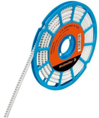
Weidmüller Leitermarkierer 3x4,2mm,weich,weiß CLI C 1-3 WS/SW Q CD Ausführung sonstige, Werkstoff Kunststoff, Länge 3mm, Breite 4,2mm, Farbe weiß, Aufdruck Buchstaben, Montageart aufschieben, Die geschlossenen Leitermarkierer sind geeignet für noch nicht angeschlossene Leitungen.
