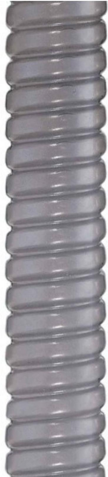
Flexa Metallschutzschlauch 38x45mm SPR-PVC-AS AD45 sw Nenndurchmesser 45mm, Nenngroße in Zoll 1 1/4 Zoll, Außendurchmesser 45mm, Innendurchmesser 38mm, Werkstoff Stahl, Oberfläche verzinkt, Ummantelungswerkstoff 1.
