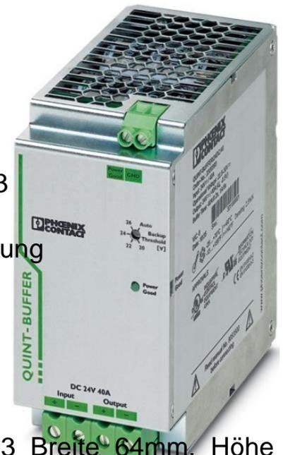
Phoenix Contact Puffermodul QUINTBUFFER #2320393 Breite 64mm, Höhe 130mm, Tiefe 125mm, QUINT Puffermodul mit wartungsfreiem Energiespeicher auf Kondensatorbasis zur Tragschienenmontage, Eingang: 24 V DC, Ausgang: 24 V DC / 40 A, mit integrierter SFB Technology (Selective Fuse Breaking Technology), inkl.
