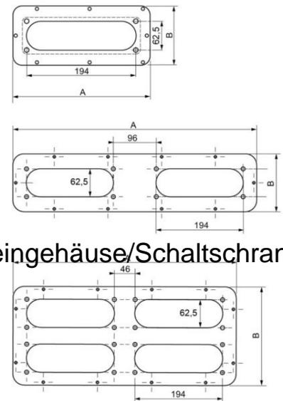
Schneider Electric Kabeleinführungsplatte 445x130 mm NSYTLEFL Breite 130mm, Höhe 445mm, Werkstoff Kunststoff, Oberfläche unbehandelt,
