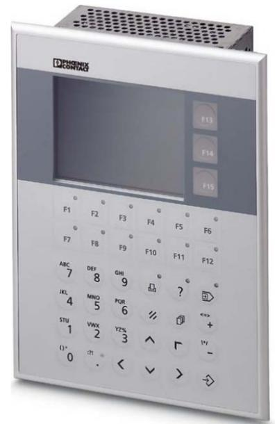
Phoenix Contact Operator Terminal OT 4M Ausführung des Displays STN, Schutzart (IP), frontseitig IP65, Betriebstemperatur 0 ...
