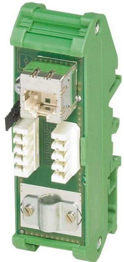
Phoenix Contact Patchpanel Cat.5e Hutschienenmontage FL-PP-RJ45-SC Anzahl der Buchsen/Kupplungen 1, Steckverbindertyp RJ45 8(8), Geschirmt, Kategorie 5E, Anschlussart sonstige, Farbe sonstige, Montageart sonstige, Höhe 90mm, Breite 29mm, Tiefe 53mm, Patchpanel, eine RJ45-Buchse auf 8 Schraubanschlussklemmen (1:1 Belegung), CAT5e, 10/100/1000 MBit/s, Tragschienenmontage, IP20, Schirmkontaktierung zur Tragschiene über Jumper wählbar
