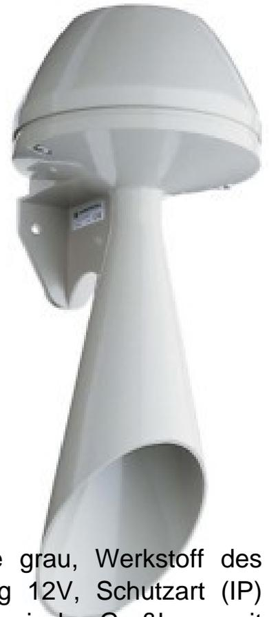
Werma Signalhupe 12V DC 570.052.54 Gehäusefarbe grau, Werkstoff des Gehäuses Kunststoff, Lautstärke 108dB, Nennspannung 12V, Schutzart (IP) IP55, Stromart DC, Stromaufnahme 0,5A, Elektromechanische Großhupe mit Trichter, Auch mit Pulston verfügbar
