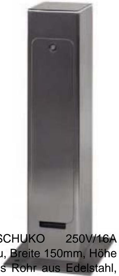
Leipziger Leuchten Elektroversorgungspoller 1xSCHUKO 250V/16A 9.946.0982.301SC16 Anzahl der Steckdosen 1, Farbe grau, Breite 150mm, Höhe 700mm, Geeignet für Schutzart (IP) IP44, Quadratisches Rohr aus Edelstahl, geschliffen und passiviert, Betrieb bei geschlossener Versorgungstür, sofern Schutzkontaktsteckdose genutzt werden.
