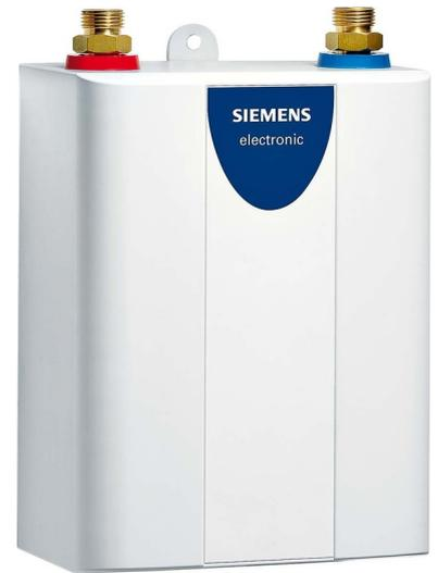
Siemens Haustechnik Durchlauferhitzer 4,4KW UT DE 05101 Nennleistung 4,5kW, Nennspannung 1 230V, Temperaturanzeige ohne, Montageart Untertisch, Heizsystem Blankdraht, Schutzart (IP) IP24, Art der Regelung elektronisch, Höhe 185mm, Breite 140mm, Tiefe 88mm, 2 in 1 System für Druck-Armatur oder Niederdruck-Armatur, verbraucht nur dann Energie, wenn Wasser gezapft wird, geeignet für Handwaschbecken.
