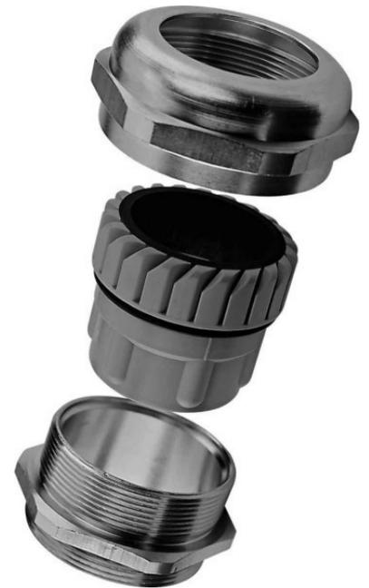
Schlemmer Kabelverschraubung M16x1,5 5-9,5mm 4220851 Gewindenengröße metrisch/PG 16, Gewindesteigung 1,5mm, Gewindelänge 5mm, Für Kabeldurchmesser 5 ...
