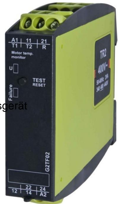
Tele Haase Überwachungsrelais B=22,5mm, 2W G2TF02 Ausführung des elektrischen Anschlusses Schraubanschluss, Mit abnehmbaren Klemmen, Anzahl der Messkreise 1, Fehlerspeicherung möglich, Externer Reset möglich, Anzahl der Kontakte als Öffner 0, Anzahl der Kontakte als Schließer 0, Anzahl der Kontakte als Wechsler 2, Breite 22,5mm, Höhe 90mm, Tiefe 103mm, Widerstandsmessbereich 1800 ...
