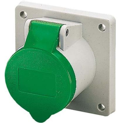
Mennekes Anbaudose TA 32A,4p,10h,>50V,IP44 1401 IEC-Stromstärke 32A, Polzahl 4, Spannung nach EN 60309-2 50-500 V (100-300 Hz) grün, Uhrzeit-Stellung 10h, Kennfarbe grün, Schutzart (IP) IP44, Anschlussstechnik Schraubklemme, Steckrichtung gerade, Werkstoff Kunststoff,
