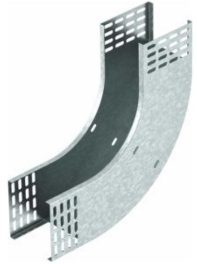
OBO Bettermann Vertr Vertikalbogen 90 Grad 110x100mm RBV 110 S FT Richtungsänderung vertikal steigend, Abbiegung (Winkel) 90°, Kabelrinnenhöhe 110mm, Kabelrinnenbreite 100mm, Ausführung ohne Verbinder, Werkstoff Stahl, Oberfläche tauchfeuerverzinkt, Einteiliger, geschlossener Vertikalbogen 90° in steigender und runder Ausführung für alle Kabelrinentypen mit der Seitenhöhe 110 mm.
