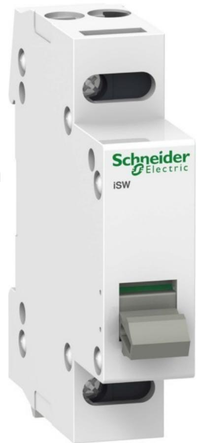
Schneider Electric Lasttrennschalter 2P 32A A9S60232 Schaltfunktion Ausschalter, Anzahl der Schließer 2, Anzahl der Öffner 0, Anzahl der Wechsler 0, Polzahl 2, Bemessungsstrom 32A, Bemessungsspannung 415V, Spannungsart AC, Farbe der Kalotte nicht zutreffend, Leuchtmittel nicht zutreffend, Lampensockel nicht zutreffend, Breite in Teilungseinheiten 2, Schutzart (IP) IP20,
