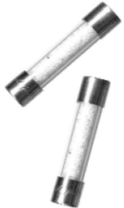
Eska G-Sicherungseinsatz F 315mA 6,3x32mm 632.012 Auslösecharakteristik flink (F), Ausführung Glassicherung, Bemessungsstrom 0,315A, Bemessungsspannung 250V, Abmessungen 6,3x32 mm, Glasrohr mit Löschmittel gefüllt, Kontaktkappen aus vernickeltem Messing
