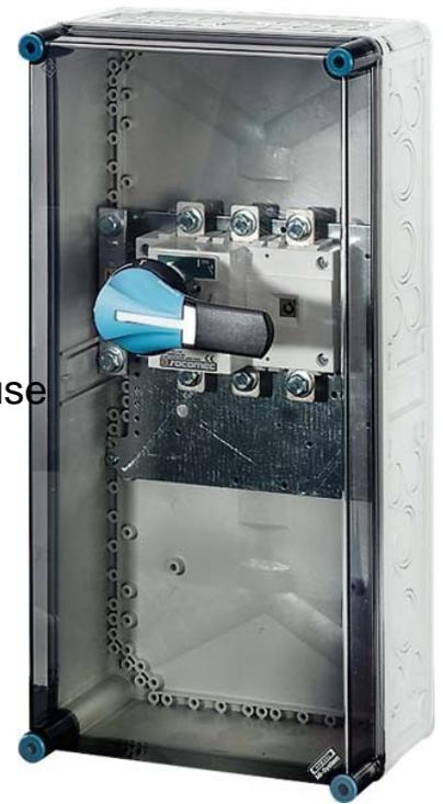
Hensel Lastschaltergehäuse 250A 3p.+PE+N Mi 7455 Ausstattung des Sicherungslasttrenngehäuses mit Lasttrennschalter, Bemessungsbetriebsstrom  $I_e$  250A, Bemessungsisolationsspannung  $U_i$  500V, Gehäusebreite 300mm, Gehäusetiefe 170mm, Gehäusehöhe 600mm, Schutzart (IP) IP65, Isolierstoffgekapselte Niederspannungs-Schaltanlage in Kastenbauform als "Typgeprüfte Schaltgeräte-Kombination" TSK nach IEC 60 439 -1 für Wandaufbau.
