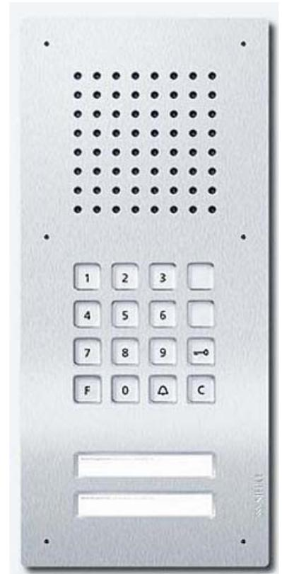
Siedle&Söhne Türstation Audio Classic, eds, 2WE CL ACOM 02 N-02 Anzahl der Ruftasten 2, Montageart Unterputz, Mit Abdeckung, Schutz gegen Vandalismus, Farbe Silber, Installationstechnik 1+n-System, Höhe 382mm, Breite 171mm, Tiefe 2mm, Classic-Türstation für das 1+n System mit Edelstahl-Front, V4A gebürstet, mit Unterputz-Gehäuse aus feuerverzinktem Stahlblech.
