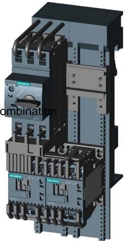
Siemens Indus.Sector Verbraucherabzweig 400VAC 7-10A 24VDC 3RA2220-1JB24-0BB4 Art des Motorstarters Wendestarter, Mit Kurzschlussauslöser, Bemessungssteuerspeisespannung  $U_s$  bei AC 50 Hz 0V, Bemessungssteuerspeisespannung  $U_s$  bei AC 60 Hz 0V, Bemessungssteuerspeisespannung  $U_s$  bei DC 24 ...
