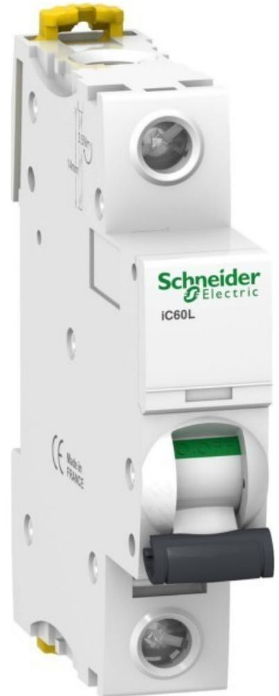
Schneider Electric LS-Schalter 1P 32A B IC60L A9F93132 Auslösecharakteristik B, Polzahl (gesamt) 1, Anzahl der abgesicherten Pole 1, Bemessungsstrom 32A, Bemessungsspannung 230V, Spannungsart AC, Frequenz 50 ...
