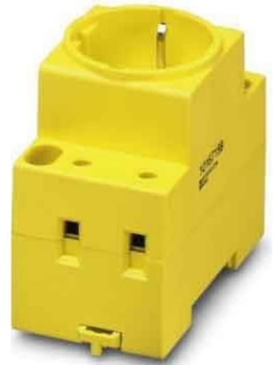
Phoenix Contact Steckdoseneinsatz VS-SI-SD-DE-G Bemessungsspannung 250V, Bemessungsstrom 16A, Spannungsart AC, Ausführung SCHUKO, Breite in Teilungseinheiten 2,5, Schutzart (IP) IP20,
