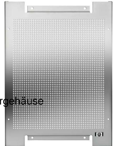
Televes Montagelochplatte 300x400 MPTLP34 Höhe 400mm, Breite 300mm, Werkstoff Stahl, Oberfläche verzinkt, Lochung, Montagelochplatte zur Installation von Multischaltern, BK-Verstärker und Erdungswinkeln.
