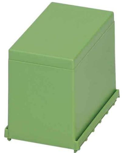
Phoenix Contact Elektronikgehäuse EMG 75-H 52MM GN Breite 75mm, Höhe 52mm, Tiefe 38mm, Werkstoff Kunststoff, Farbe grün, Rastermaß (TE) 0,075, Betriebstemperatur -40 ...
