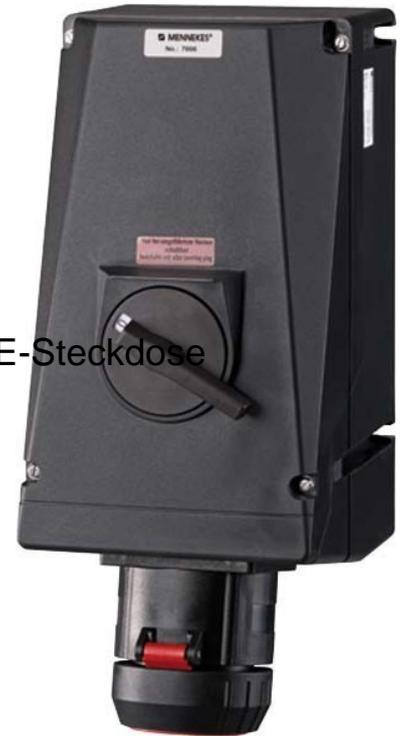
Mennekes EX-Wandsteckdose Zone 22 125A5P 6h400V IP66 7886 Polzahl 5, Nennstrom 125A, Spannung nach EN 60309-2 400 V (50+60 Hz) rot, Uhrzeit-Stellung 6h, Kennfarbe rot, Werkstoff des Gehäuses Kunststoff, Für Ex-Zone Staub 22,
