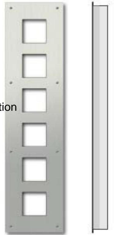
TCS Tür Control Frontplatte UP für 6 AMI-Module ZAU2006-0030 Anzahl der Einheiten 1, Werkstoff sonstige, Farbe Silber, Montageart Unterputz, Höhe 200mm, Breite 760mm, Tiefe 3mm, Frontplatte 3 mm Edelstahl geschliffen, zum Einbau von Modulen der Serie AMI in individualisierter Bestückung, Ausschnittsmaß 82 mm x 82 mm, Modulrasterabstand 120 mm, UP Kasten
