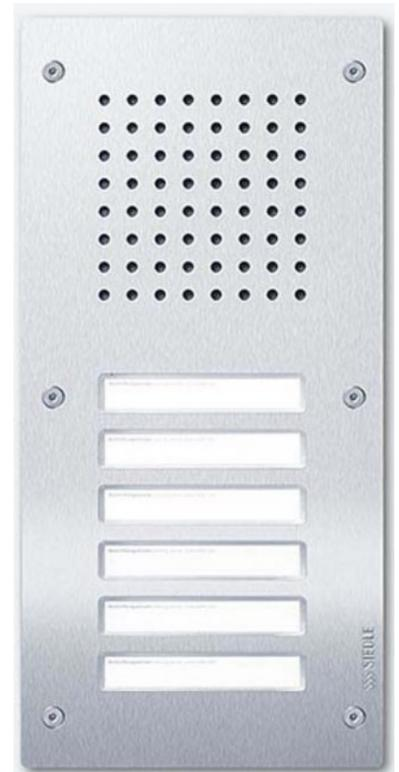
Siedle&Söhne Türstation Audio Classic, eds, 6 WE CL 111-6 N-02 Anzahl der Ruftasten 6, Montageart Unterputz, Mit Abdeckung, Schutz gegen Vandalismus, Farbe Silber, Installationstechnik 1+n-System, Höhe 356mm, Breite 171mm, Tiefe 2mm, Classic-Türstation für das 1+n System mit Edelstahl-Front, V4A gebürstet, ohne Gehäuse zur Montage auf vorhandenes Unterputzgehäuse ¿Größe C¿ der Baureihe TL 111.
