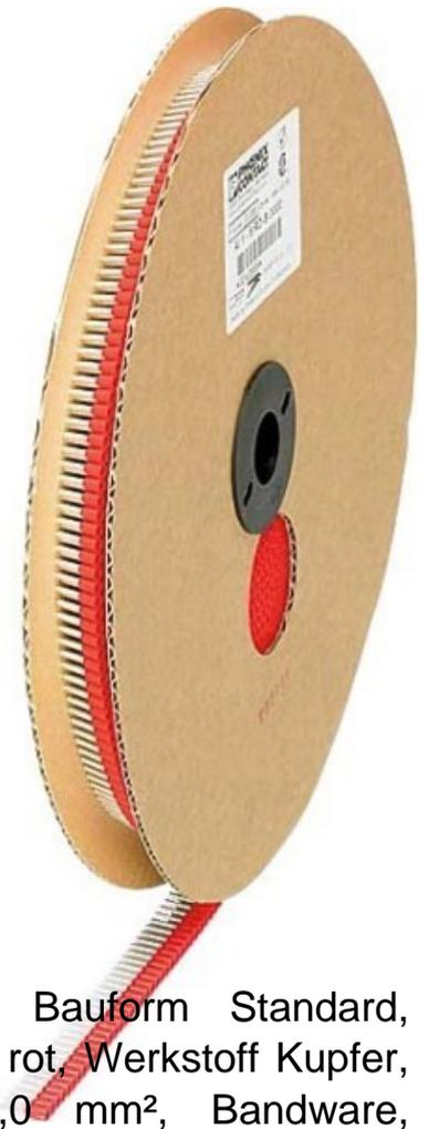
Phoenix Contact Aderendhülse AI 1-8 RD-B 3000 Bauform Standard, Nennquerschnitt 1mm<sup>2</sup>, Hülsenlänge 8mm, Isoliert, Farbe rot, Werkstoff Kupfer, Oberfläche verzinkt, Bandware, Aderendhülsen, 1,0 mm<sup>2</sup>, Bandware, Hülsenlänge: 8 mm, mit Kunststoffkragen, galvanisch verzinkt, Farbe: rot, Farbreihe nach DIN 46228-4, CSA-zertifiziert
