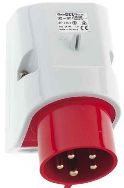
Eigenschaften: - Leitungseinführung einmal oben (offen), zweimal unten (verschlossen) - Gehäuseunterteil um 180° drehbar - 4 Befestigungsbohrungen im Gehäuseboden zum Ausbrechen - geeignet für Durchgangsverdrahtung mit Spezialklemmen
