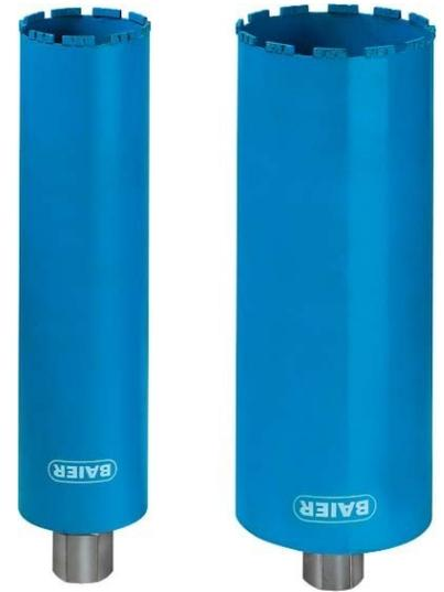
Baier Maschinenfabrik Nassbohrkrone f.8131/817/832 58651 Nennmaß 152mm, Aufnahmesystem Gewindeaufnahme, Arbeitstiefe 400mm, Beschichtung Diamant, Geeignet für Nassbetrieb, Diamantnassbohrkrone Premium, mit Gewindeaufnahme 1 1/4 Zoll, Einsatzgebiet Beton, Beton armiert, Klinker
