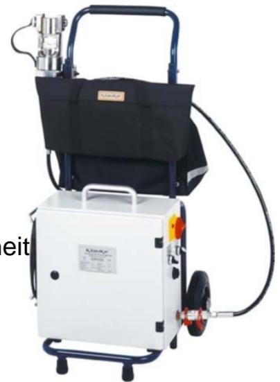
Klauke Antriebsaggregat hydraulisch EHP4230 Ausführung/Betätigung elektro-hydraulische Pumpe, Nenndruck 700bar, Elektrohydraulisches Antriebsaggregat, kompatibel zu hydraulischen Press- und Schneidköpfen, Stromschienenbearbeitungswerkzeugen, zu Stanzen für Stromschienen und zu Lochstanzwerkzeugen (Rund- und Formlocher), Adapter sind gesondert zu bestellen
