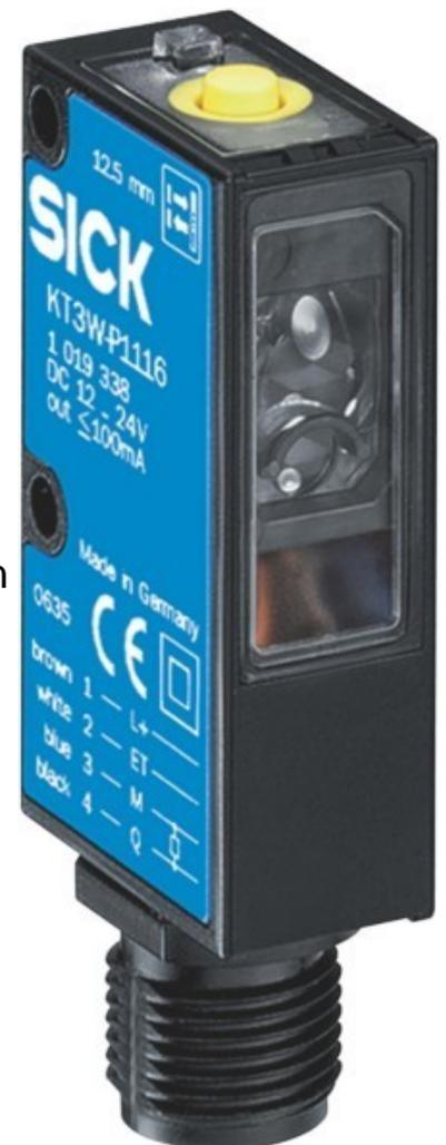
Sick Kontrasttaster M12, Tw=12,5 mm KT3W-P1116 Anzahl der Halbleiter-Ausgänge mit Meldefunktion 1, Anzahl der kontaktbehafteten Ausgänge mit Meldefunktion 0, Ausführung des elektrischen Anschlusses Steckverbinder M12, Ausführung des Schaltausgangs PNP, Betriebsmittel-Schutzklasse Schutzklasse 2, Bemessungssteuerspeisespannung Us bei DC 12 ...
