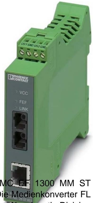
Phoenix Contact LWL-Konverter 10/100BASE-T(X) FL MC EF 1300 MM ST Ethernet, Höhe 99mm, Breite 22,5mm, Tiefe 114,5mm, Die Medienkonverter FL MC EF WDM ermöglichen durch die WDM-Technologie (Wavelength Division Multiplex) eine Vollduplex-Kommunikation mit nur einer Glasfaser.
