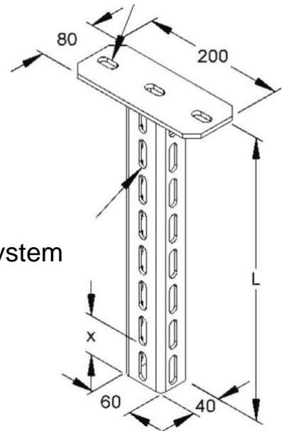
Niadax Hängestiel HU 6040/1300 Länge 1300mm, Profilbreite 60mm, Profilhöhe 40mm, Ausführung U-Profil, Werkstoff Stahl, Werkstoffgüte sonstige, Oberfläche tauchfeuerverzinkt, Farbe ohne,
