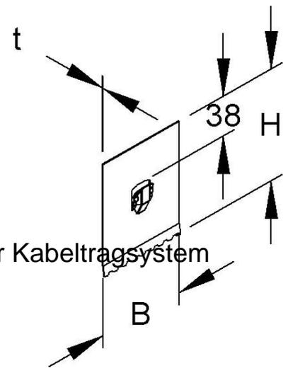
Niadax Trennprofilhalter TPHRS 110 Bauform Schraubset, Geeignet für Kabelrinne, Befestigungsart Schraubbefestigung, Werkstoff Stahl, Werkstoffgüte sonstige, Oberfläche bandverzinkt,
