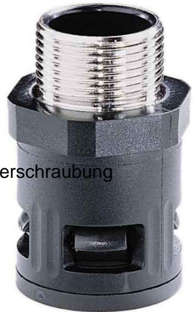
Flexa Schnellverschraubung RQGK-M AD13,0 M12 Nenndurchmesser 13mm, Nenngröße in Zoll 5/16 Zoll, Schutzart (IP) IP68, Ausführung gerade, Bauform Außengewinde, Verbindungsart Gewinde, Gewindeart metrisch, Gewindeanschlussgröße M12 x 1,5, Gewinde Gangzahl 1,5, Gewindewerkstoff
