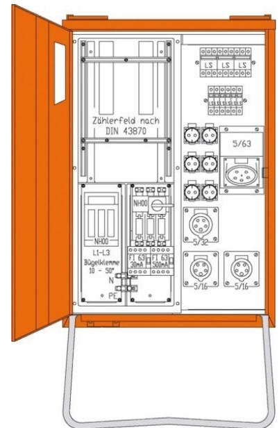
Walther Werke Anschlussverteiler 44kVA WAV0170-Lux Ausführung Anschlussverteilerschrank, Anzahl der CEE-Steckdosen 16 A / 400 V / 5-polig 2, Anzahl der CEE-Steckdosen 32 A / 400 V / 5-polig 1, Anzahl der CEE-Steckdosen 63 A / 400 V / 5-polig 1, Anzahl der SCHUKO-Steckdosen 6, Anzahl der Zählerfelder 1, Hauptschalter NH00, Hauptschalter-Bemessungsstrom 63A, Schutzart (IP) IP44, Bemessungsspannung 230/400 V, Anzahl der CEE-Steckdosen 125A / 400V / 5-polig 0,
