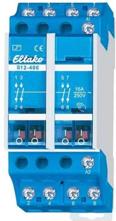
Eltako Stromstoßschalter 4S 16A S12-400-110V DC Funktion sonstige, Montageart DIN-Schiene, Breite in Teilungseinheiten 2, Einbautiefe 55mm, Anzahl der Schließer 4, Anzahl der Öffner 0, Anzahl der Wechsler 0, Steuerspannung 1 110 ...
