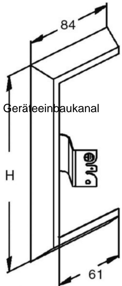
Nidax Wandrosette GWR 133 H Breite 181mm, Tiefe 61mm, Ausführung universal, Montageart des Kanals Wand, Werkstoff Stahl, Werkstoffgüte sonstige, Halogenfrei, Oberfläche bandverzinkt und beschichtet, Farbe sonstige, RAL-Nummer 1013, Separater Anschluss an den Potentialausgleich erforderlich
