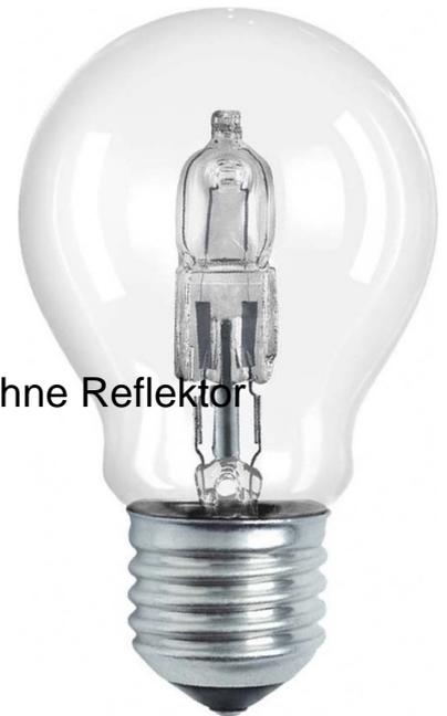
Osram Halogenlampe ECO PRO 20W 230V E27 64541 A PRO Lichtstrom 235lm, Mittlere Nennlebensdauer 2000h, Energieeffizienzklasse D, Lampenleistung 20W, Lampenspannung 230 ...
