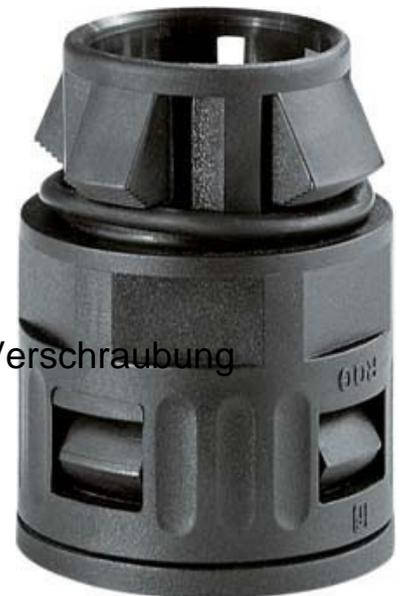
Flexa Schnellverschraubung RQG1-S AD13,0 sw Nenndurchmesser 13mm, Nenngröße in Zoll 5/16 Zoll, Schutzart (IP) IP66, Ausführung gerade, Bauform sonstige, Verbindungsart Steckanschluss, Gewindeart sonstige, Gewindeanschlussgröße sonstige, Gewindewerkstoff Polyamid (PA), Gewindelänge 13,6mm, Gesamtlänge 38,6mm, Werkstoff Polyamid (PA),
